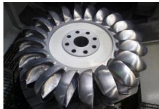
Turbine Pelton (similaire à celle utilisée pour le projet)
