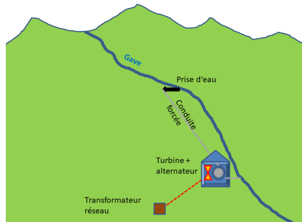
Schéma de principe d'une centrale avec prise au fil de l'eau
